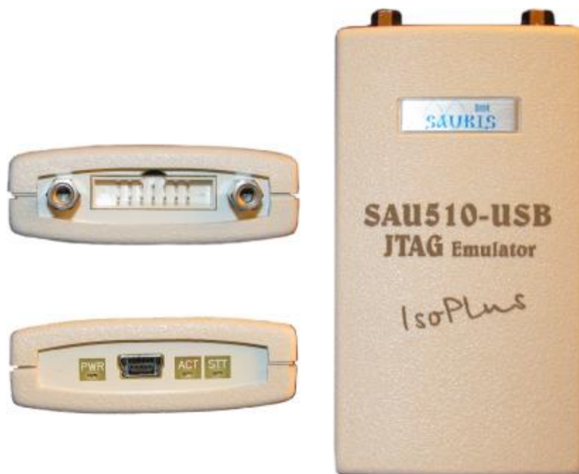
Рис. 1-2. Внешний вид JTAG эмулятор SAU510-USB ISO PLUS
