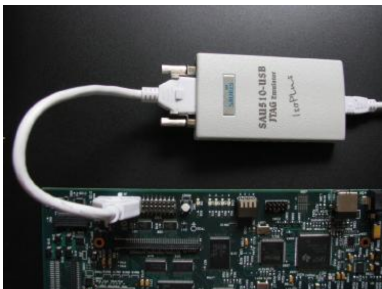
Рис. 2-1. Подключение SAU510-USB ISO PLUS к отладочной плате и ПК
